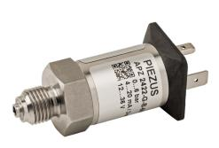
Датчик давления APZ 2422 серии OEM с погрешностью ≤0,5% от диапазона измерений предназначен для общепромышленного применения и объектов ЖКХ. Сенсор с разделительной мембраной из нержавеющей стали, установленный методом приварки, позволяет использовать этот датчик давления в промышленном холодильном оборудовании. Изготавливается в многодиапазонном исполнении. Для переключения диапазонов и корректировки нулевого значения используется конфигуратор ZCON 100 (поставляется отдельно).
