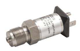
Датчик давления APZ 2412 OEM серии общепромышленного применения на основе тензорезистивного сенсора с керамической мембраной с погрешностью ≤0,5% от диапазона измерений.
