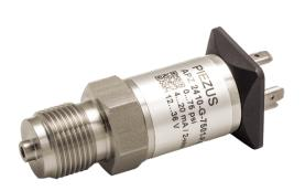
Датчик давления APZ 2410 OEM серии для общепромышленного применения с погрешностью ≤1% от диапазона измерений на основе тензорезистивного сенсора с керамической мембраной.
