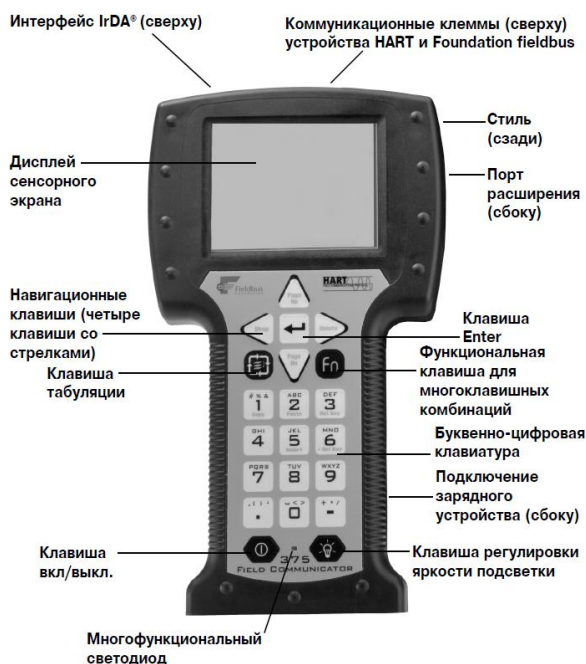
Рисунок Д.1 – Назначение элементов управления коммуникатора модели 375
